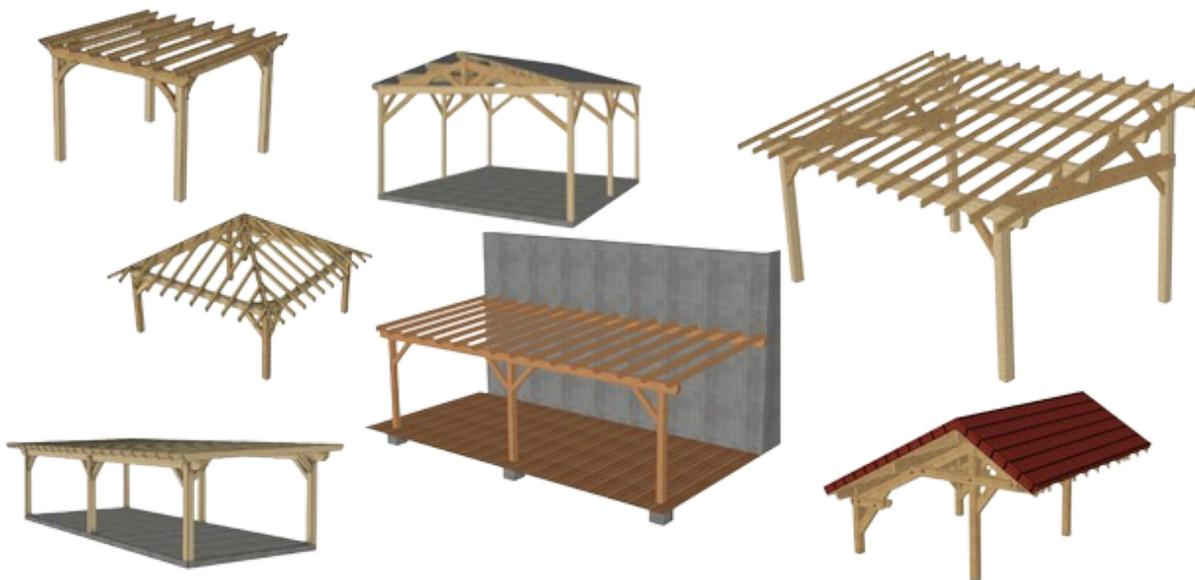
**Fabriqué sur mesure en KVH (Bois Massif Abouté) et Lamellé collé.**
