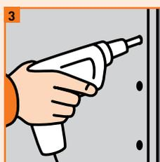
3 Fixer une 1<sup>ère</sup> plaque sur l'ossature à l'aide d'une visseuse électrique (vis FERMACELL 3,9 x 30 mm)
