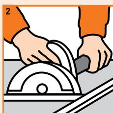
2 Découper la plaque à l'aide d'une scie circulaire (lame de carbure) avec aspirateur ou d'une griffe FERMACELL.
