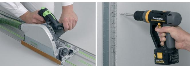
Scie circulaire lame de carbure pour la découpe de la plaque
