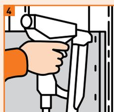
4 ou à l'aide d'une agrafeuse pneumatique (agrafe sur ossature bois).
