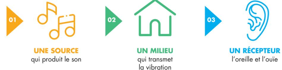
La vibration de la source provoque une variation de la pression de l'air. Elle se **propage dans un milieu** (solide, liquide ou gazeux) jusqu'à atteindre un récepteur qui analysera l'information. Cette variation de pression est appelée **pression acoustique**.
