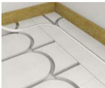
Introduire les tubes d'un diamètre de 16 mm dans les rainures disposées à cet effet. Une simple pression verticale du pied suffit à les maintenir en place. Aucun accessoire de maintien supplémentaire n'est nécessaire.
